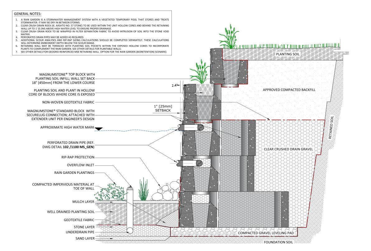
**GRAVITY-BIORETENTION POND DETAILS**
